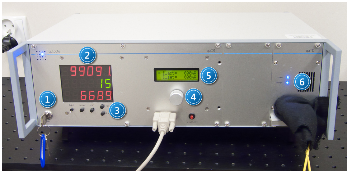
Zdjęcie 5. Jednostka pomiarowa – kontroler, wielofunkcyjny zasilacz, detektory pojedynczych fotonów: 1 – główny włącznik modułu; 2 – wyświetlacz zliczeń; 3 – przyciski funkcji licznika; 4 – pokrętło zmiany parametrów lasera; 5 – wyświetlacz ustawionych parametrów lasera; 6 – wskaźniki stanu pracy modułu APD.
